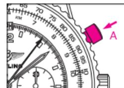
2. Для прекращения измерения следует опять нажать кнопку **A**. Таким образом можно измерить несколько отрезков времени и суммировать их.
