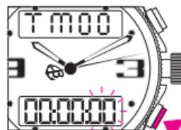
I giorni (max. 99 giorni) sul display superiore lampeggiano. Premendo brevemente il pulsante B, le H, i MIN, e i SEC del display inferiore lampeggiano in successione.
