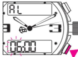
После короткого нажатия на кнопку В на дисплее начнут последовательно друг за другом мерцать индикаторы H и MIN.
