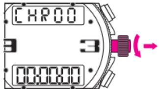
В том случае, когда при выборе функции **CHR** секундная стрелка не встала точно на 12-часовой отметке, следует установить головку часов в позицию 2 и вращать ею по направлению вперед до тех пор, пока она не встанет на отметку 12. Затем головку следует вернуть в позицию 1.
