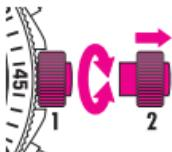
Corona: iluminación del display mediante presión, selección de las funciones mediante rotación (posición 1), ajuste de las funciones o selección del idioma mediante rotación (posición 2).
