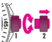
Couronne: éclairage du display par pression, sélection des fonctions par rotation (position 1), réglage des fonctions ou choix d'une langue par rotation (position 2).
