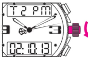
リューズを回してデジタル時表示を合わせます。プッシュボタンBを短く1回押してデジタル分表示を点滅させ、リューズを回してデジタル分表示を合わせます（分表示は15分単位で変わります）。最後にリューズをニュートラル位置（1）に押し戻します。
