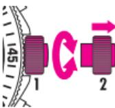
Krone: Displaybeleuchtung durch Drücken. Funktionswahl durch Drehen in Position 1. Funktionsregulierung oder Sprachwahl durch Drehen in Position 2.
