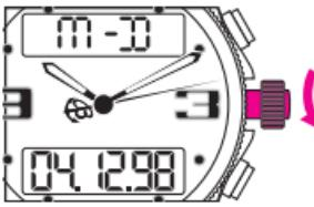
Las correcciones respectivas se efectúan mediante rotación de la corona. Pulsar la corona en posición 1.
