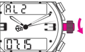
Les réglages respectifs des H et des MIN de l'alarme-réveil s'opèrent par rotation de la couronne. Repousser la couronne en position 1.
