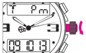
请旋转表冠顺序对小时、分钟和秒钟的时间显示进行调校。调校完成后，将表冠推回位置1。
