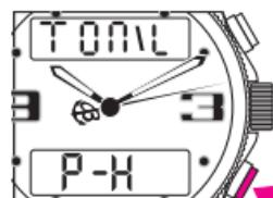
На нижнем дисплее появилось обозначение **P-H**: акустический сигнал прозвучит при каждом нажатии на кнопки часов + часовой сигнал.
