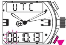
Una presión corta en el pulsador B: las H y los MIN del display parpadean sucesivamente.
