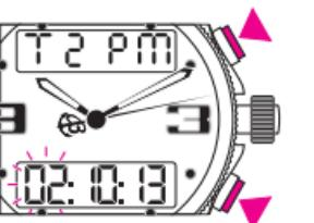
Se puede obtener la indicación de la hora en modalidad 24H o AM/PM mediante una presión corta en el pulsador A.
