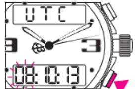
Pressão curta sobre o botão B: sucessivamente as H e os MIN da indicação ficam intermitentes.
