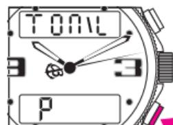
На нижнем дисплее появилась буква **P**: акустическое подтверждение будет звучать при каждом нажатии на кнопки часов.
