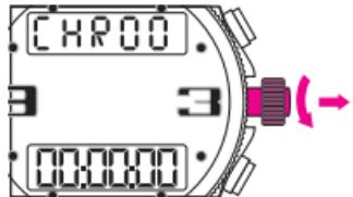
Si l'aiguille des secondes ne se positionne pas précisément à 12H en mode **CHR**, tirer la couronne en position 2 et tourner en avant pour repositionner l'aiguille à 12H. Repousser la couronne en position 1.
