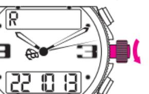
Синхронизация стрелок осуществляется за счет вращения головки. Примечание: Секундная стрелка передвигается только в направлении движения часовой стрелки. Головку установить в позицию 1.
