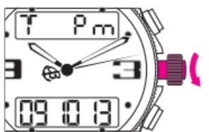
Pressão curta sobre o botão B: sucessivamente, as horas, os minutos e os segundos (as H, os MIN e os SEG) ficam intermitentes.
