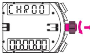
Si la aguja de los segundos no se posiciona exactamente en 12H en la modalidad **CHR** (cronógrafo), tirar de la corona hasta su posición 2 y girarla hacia delante hasta que la aguja se posicione en 12H. Pulsar la corona en 1.
