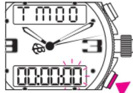
腕表上方显示窗口的日数（最长99天）开始闪烁。短暂压按按钮B，位于腕表下方显示窗口的时H、分MIN、秒SEC会顺序闪烁。
