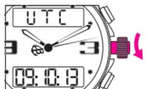
Su ajuste respectivo se efectúa mediante rotación de la corona. N.B. La corrección de los minutos se efectúa por fracciones de 15 minutos. Pulsar la corona en posición 1.
