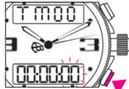
Los días (máx. 99 días) del display superior parpadean, y mediante presión corta en el pulsador B parpadean sucesivamente las H, los MIN y los SEG del display inferior.
