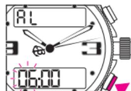
プッシュボタンBを短く1回押すとアラームのデジタル時表示が点滅します。
