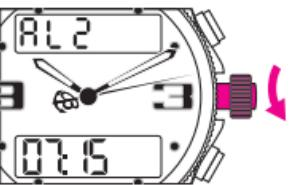
Die jeweiligen Regulierungen der H und der MIN des Alarmweckers erfolgen durch Drehen der Krone. Die Krone in Position 1 zurückstossen.
