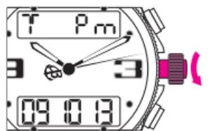
Las correcciones respectivas de las H, los MIN y los SEG se efectúan mediante rotación de la corona. Pulsar la corona en posición 1.
