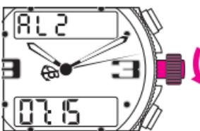
リューズを回してアラームのデジタル時表示を合わせます。プッシュボタンBを短く1回押してアラームのデジタル分表示を点滅させ、リューズを回してアラームのデジタル分表示を合わせます。最後にリューズをニュートラル位置（1）に押し戻します。アラーム音を止めるにはプッシュボタンまたはリューズを押してください。
