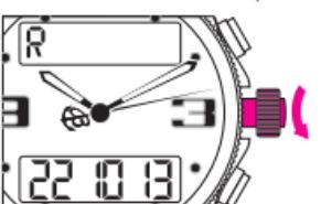
請旋轉錶冠順序對小時、分鐘和秒鐘指針時間的顯示進行同步的調校。注意：秒針僅能順時針方向旋轉。同步完成後，將錶冠壓回位置1。
