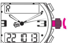
Die jeweilige Synchronisation der analogen H, MIN und SEK (Zeiger) erfolgt durch Drehen der Krone. N.B. Die SEK bewegen sich nur im Uhrzeigersinn vorwärts. Die Krone in Position 1 zurückstoßen.
