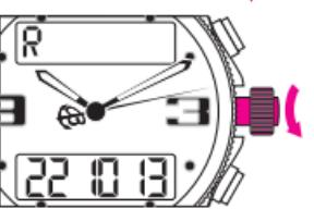
A sincronização respectiva das H, dos MIN e dos SEG analógicos (ponteiros) opera-se por rotação da coroa.
