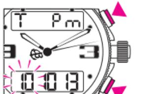
A hora pode ser indicada no modo 24 H ou AM/PM por uma pressão curta sobre o botão A. No modo AM/PM, a indicação do mostrador superior pode ser suprimida por uma pressão sobre A.
