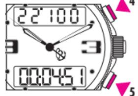
pusshubuton Aを押すと、クロノグラフがストップし、上部デジタル表示窓に計測結果 (ADD) が表示されます。
