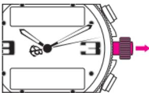
Colocar la corona en posición neutra y tirar seguidamente hacia afuera hasta su posición 2.
