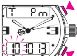
После короткого нажатия на кнопку А выбрать время или в 24-часовом цикле или в режиме AM/PM. В режиме AM/PM, коротко нажав на кнопку А, верхний дисплей можно затемнить.
