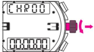
如果在**CHR**的模式下，秒針沒有正確指示在12時的位置，請將錶冠拉至位置2，並以順時針方向旋轉，將秒針再定位在12時的位置。完成後，將錶冠推回位置1。
