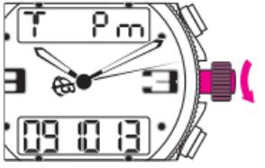
Die jeweiligen Korrekturen der H, MIN und SEK erfolgen durch Drehen der Krone. Die Krone in Position 1 zurückstossen.
