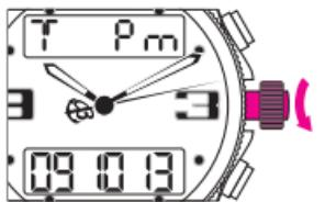
Les corrections respectives des H, des MIN et des SEC s'opèrent par rotation de la couronne. Repousser la couronne en position 1.
