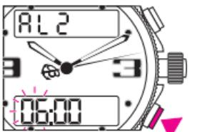
プッシュボタンBを短く1回押すとアラームのデジタル時表示が点滅します。
