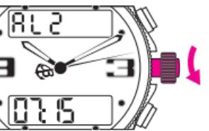
Os acertos respectivos das H e dos MIN do alarme-despertador efectuam-se por rotação da coroa. Recolocar a coroa na posição 1.
