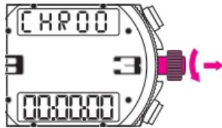
Se o ponteiro dos segundos não se posiciona exactamente nas 12H no modo CHR, puxar a coroa na posição 2 e girar para a frente para reposicionar o ponteiro nas 12H. Recolocar a coroa na posição 1.
