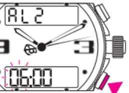
Una presión corta en el pulsador B: las H y los MIN del display parpadean.
