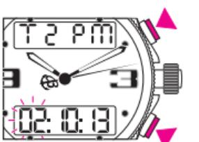
L'heure peut être affichée en mode 24H ou AM/PM par une pression courte sur le poussoir A.
