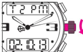
Su ajuste respectivo se efectúa mediante rotación de la corona.
