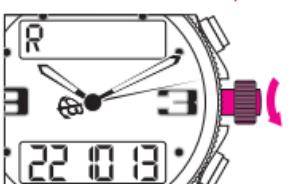
La sincronización respectiva de las H, los MIN y los SEG analógicos (agujas) se efectúa mediante rotación de la corona.
