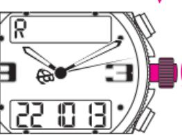
La synchronisation respective des H, des MIN et des SEC analogiques (aiguilles) s'opère par la rotation de la couronne. N.B. Les SEC n'avancent que dans le sens horaire. Repousser la couronne en position 1.
