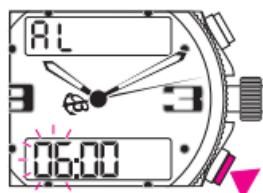
Una presión corta en el pulsador B: las H y los MIN del display parpadean sucesivamente.
