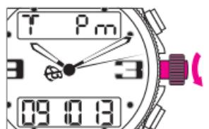
プッシュボタンBを短く1回押してデジタル時表示を点滅させます。リューズを回してデジタル時表示を合わせます。プッシュボタンBを短く1回押してデジタル分表示を点滅させ、リューズを回してデジタル分表示を合わせます。プッシュボタンBを短く1回押してデジタル秒表示を点滅させ、リューズを回してデジタル秒表示を合わせます。最後にリューズをニュートラル位置 (1) に押し戻します。
