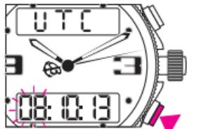
pusshボタンBを短く1回押してデジタル時表示を点滅させます。
