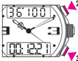
Остановка хронографа: верхний показатель (ADD) показывает время, измеряемое с точностью до 1/100 сек. или прошедшие дни.
