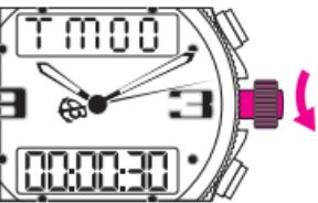
Las correcciones respectivas de los días, H, MIN, SEG se efectúan mediante rotación de la corona. Pulsar la corona en posición 1.
