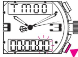
Die Tage (max. 99) erscheinen blinkend auf der oberen Anzeige. Durch kurze Betätigung des Drückers B blinken die H, MIN und SEK nacheinander auf der unteren Anzeige.
