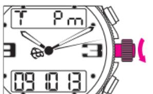
請旋轉錶冠順序對小時、分鐘和秒鐘的時間顯示進行調校。調校完成後，將錶冠推回位置1。
