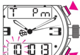
時刻は24時間表示、AM/PM表示から選択できます。プッシュボタンAを短く押して選択します。
