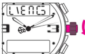
Die Sprachwahl erfolgt über die Funktion **TOML** durch Drehen der Krone in Position 2. Es stehen vier Sprachen zur Verfügung: Französisch (FRA), Deutsch (DEU), Englisch (ENG), Spanisch (ESP). Die Krone in Position 1 zurückstossen.
