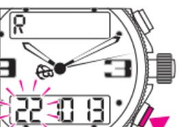
Pression courte sur le poussoir B: successivement, les heures, les minutes et les secondes (les H, les MIN et les SEC) de l'affichage clignotent.
