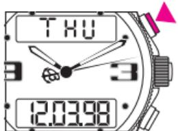
Kurze Betätigung des Drückers A: Anzeige oder Ausblendung des Tages.
