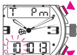
La indicación de la hora puede obtenerse en modalidad 24H o AM/PM mediante una presión corta en el pulsador A. En modalidad AM/PM se pueden suprimir las indicaciones del display superior mediante una presión en A.
