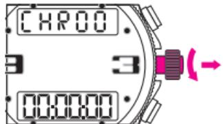
如果在CHR的模式下，秒针没有正确指示在12时的位置，请将表冠拉至位置2，并以顺时针方向旋转，将秒针再定位在12时的位置。完成后，将表冠推回位置1。
