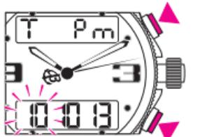
L'ora può essere indicata in due modi – 24H oppure AM/PM – premendo brevemente il pulsante A. Nel modo AM/PM l'indicazione del display superiore può essere eliminata premendo il pulsante A.
