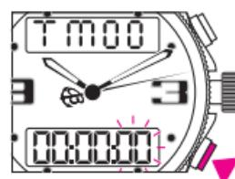
上部デジタル表示窓に日数（最大99日）が点滅します。リューズを回して正しい日数に合わせます。
