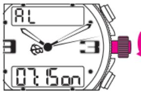
Las correcciones respectivas de las H y los MIN de la alarma-despertador se efectúan mediante rotación de la corona. Pulsar la corona en posición 1: la alarma se activa.
