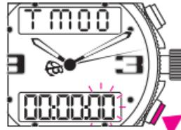
Os dias (max. 99 dias) na indicação superior ficam intermitentes e por uma pressão curta sobre o botão B, as H, MIN e SEG na indicação inferior, ficam intermitentes sucessivamente.
