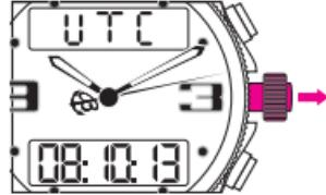
Seleccionar la función **UTC** tirando seguidamente de la corona hasta su posición 2.
