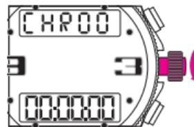
クロノグラフ (CHR) を選択しても秒針が正確に12時位置に移動しない場合は、リューズを引き出した位置 (2) で回して正確に12時位置に合わせます。最後にリューズをニュートラル位置 (1) に押し戻します。
