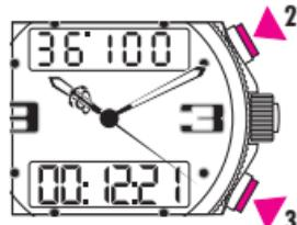
pusshubuton Aをもう一度押すと、クロノグラフがストップします。上部デジタル表示窓には計測結果 (ADD) が1/100秒単位で表示されます。計測時間が1日を超える場合は、経過日数が1/100秒単位の計測結果と交互に表示されます。
