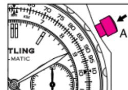
2. Interrumpir la medida presionando nuevamente el pulsador **A**. La medida se efectúa en horas (contador **H**), minutos (contador **M**), segundos y 1/4 de segundo (aguja **C**).
