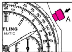
2. Interromper a medição pressionando novamente o pistão **A**. A medição é efectuada em horas (contador **H**), minutos (contador **M**), em segundos e em  $\frac{1}{4}^{\circ}$  de segundo (ponteiro **C**).
