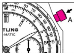
2. Fermare la misurazione premendo di nuovo il pulsante **A**. La misura si effettua in ore (totalizzatore **H**), in minuti (totalizzatore **M**), in secondi e in quarti di secondo (lancetta **C**).
