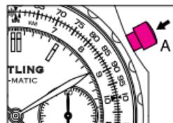
2. *Zeitmessunterbrechung:* Stopp und Start durch Betätigen des Drückers **A**. So lassen sich mehrere Zeitspannen messen und kumulieren.
