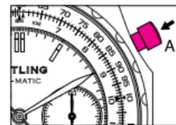
2. Para interromper a medição, volte a pressionar o pistão **A**. Para retomar a medição, pressione o pistão **A**. Deste modo é possível acumular a medição de vários tempos curtos.
