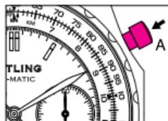
2. Pour interrompre la mesure, appuyer à nouveau sur le poussoir **A**. Pour reprendre la mesure du temps, appuyer sur le poussoir **A**. Il est ainsi possible de cumuler plusieurs temps courts.
