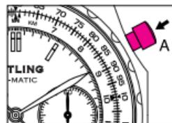
2. Para interrumpir la medición, presionar nuevamente el pulsador **A**. Para reanudar la medición, presionar el pulsador **A**. esta operación permite la acumulación de varios tiempos cortos.
