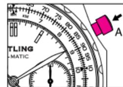
2. Arrêter la mesure en appuyant à nouveau sur le poussoir **A**. La mesure s'effectue en heures (compteur **H**), minutes (compteur **M**), en secondes et  $\frac{1}{4}^e$  de seconde (aiguille **C**).
