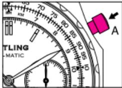
2. クロノグラフを停止させるには、もう一度ボタンAを押します。経過時間は、時 (H)、分 (M)、1/4秒 (指針 C) 単位で測定できます。
